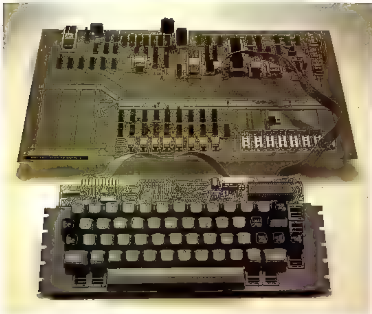
Le circuit imprimé du micro-ordinateur « Micro-Systèmes 1 » et son clavier. Remarque: la façon dont se connecte le clavier sur la carte.
